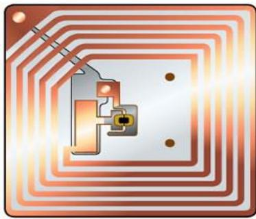
Fig. 3: Basic RFID Tag.
