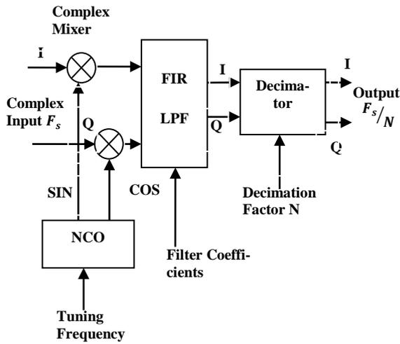
Fig. 1:Block Diagram of DDC.
