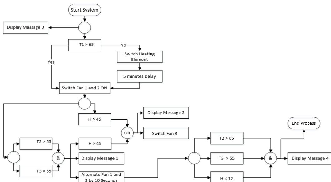
**Fig. 4:** Controller Diagram
