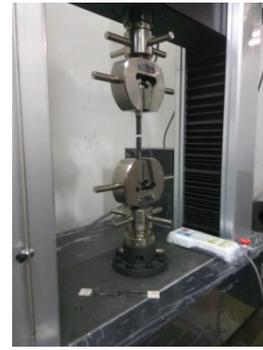
Fig.4. Tensile Test Machine
