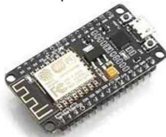
Fig. 3: ESP8266-12E NodeMCU v-1.0
