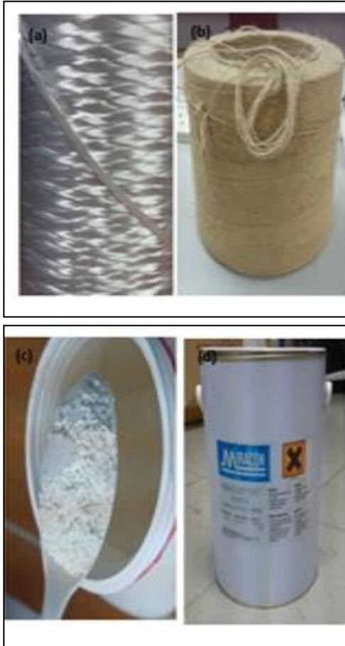
Fig. 1 : Materials used ; (a) glass roving; (b) kenaf yarn; (c) montmorillonite clay; (d) epoxy
