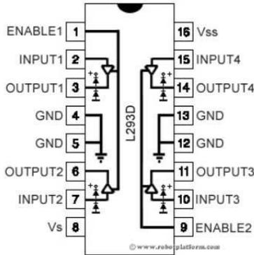
Fig. 7: IC diagram
