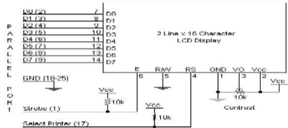
Fig. 6: LCD display
