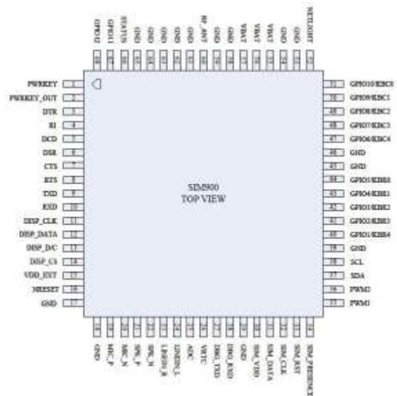
Fig. 7: GSM module
