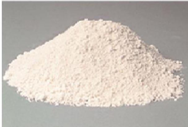
**Fig. 1:** Sample of Met kaolin.
