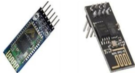
Fig. 7: (a). Bluetooth module (b). Wi-Fi module
