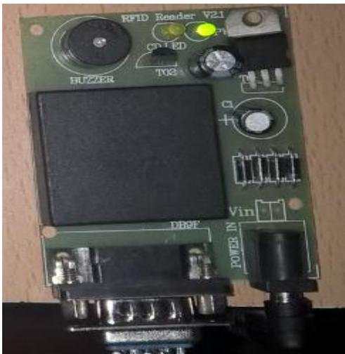
Fig. 3: RFID Reader Module
