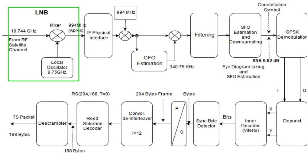
Fig. (2). Conceptual System Block Diagram
