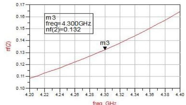
Fig. 5: Noise Figure of LNA.
