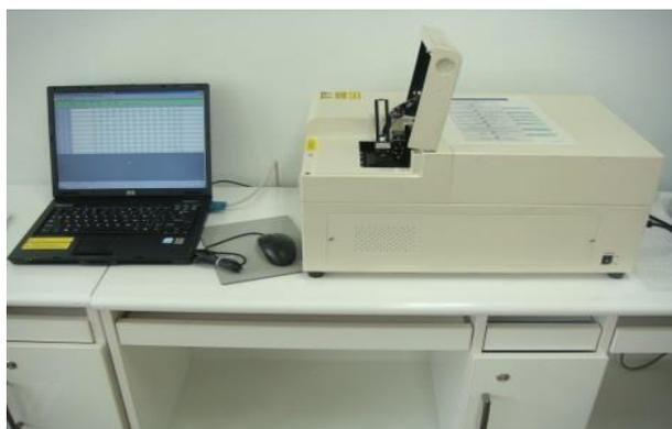
Fig. 2: Glass Dosimeter.
