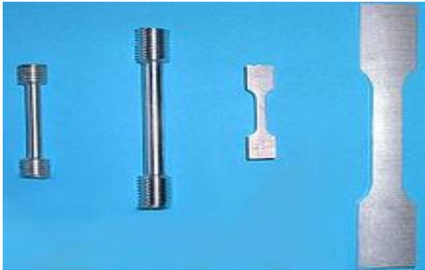
Fig. 21: Tensile Specimen.
