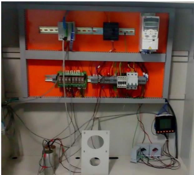
**Fig. 5:** PLC Arrangement
